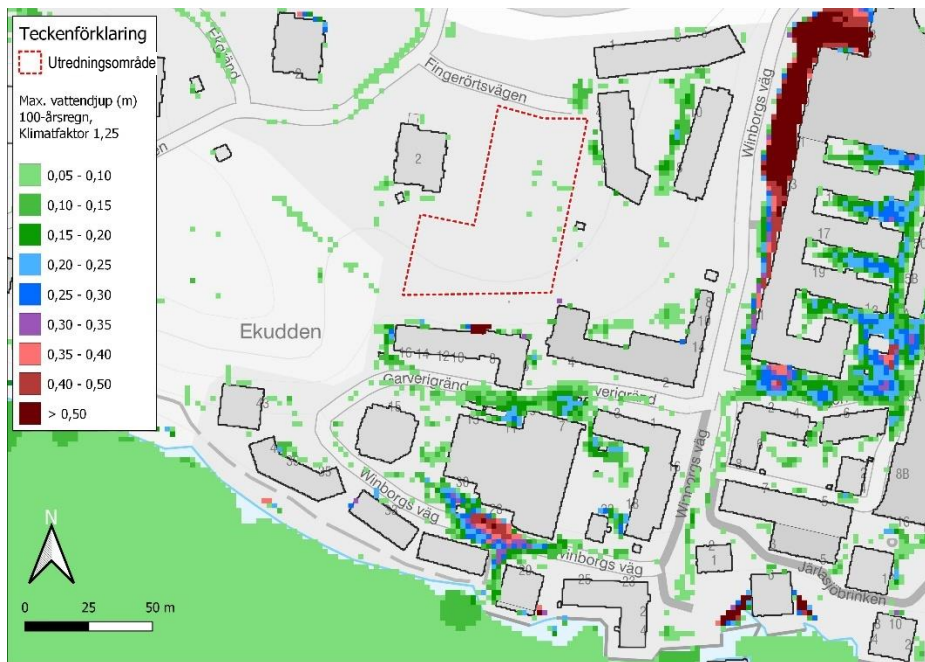
Figur 6-6. Modellerat översvämningsdjup i samband med 100-årsregn (utan invallning).
